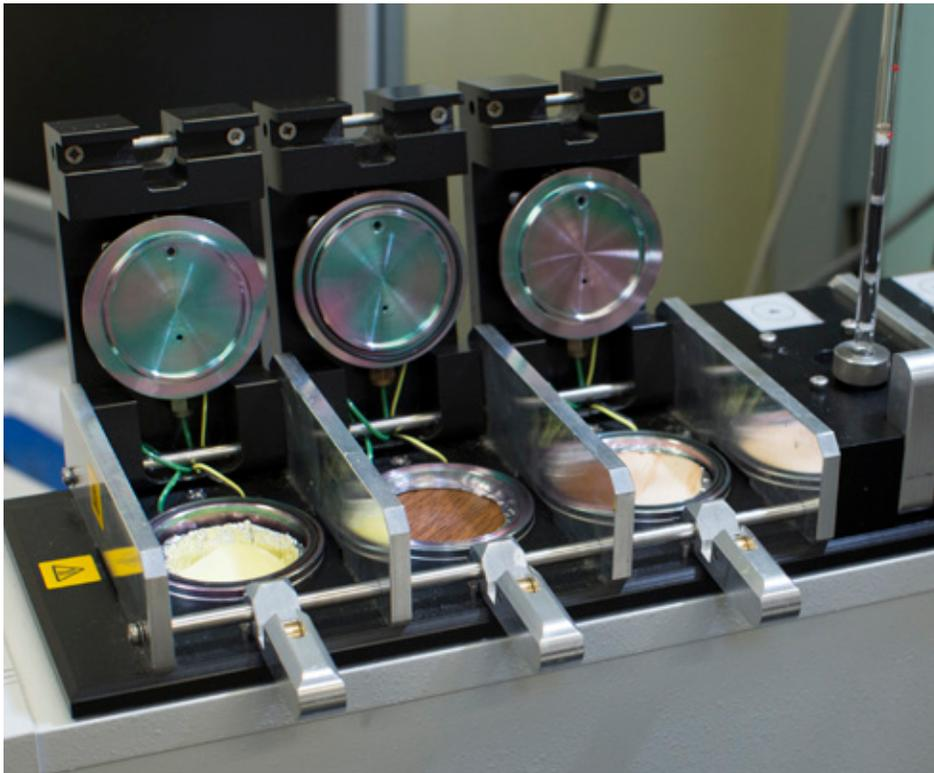
Micro-chambre utilisée pour dépister les émissions de COV à partir de matériaux de construction solides
