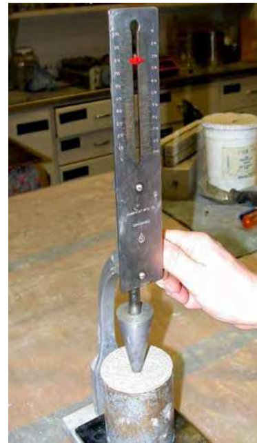
Figure 10 Le cône de Vicat tombe librement dans un cylindre de mortier et la profondeur de pénétration dans le mortier donne un indice de la consistance du mortier.
