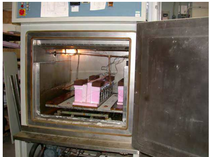
Figure 5 Essai sur prismes de maçonnerie dans le caisson d'essai des cycles gel-dégel de l'IRC-CNRC. Le caisson utilise une méthode d'essai de cycles unidirectionnels adaptée aux climats canadiens 1 .
