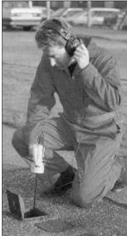
Figure 2. Parmi les appareils d'auscultation typiques se trouvent les tiges d'écoute (gauche) et les microphones au sol (droite). Photo : Palmer Environmental Ltd.
