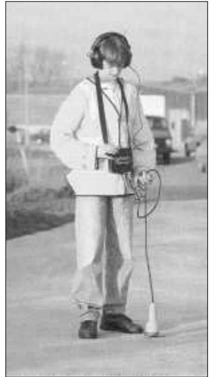
Figure 2. Parmi les appareils d'auscultation typiques se trouvent les tiges d'écoute (gauche) et les microphones au sol (droite). Photo : Palmer Environmental Ltd.
