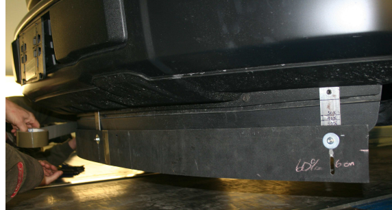
(d) Adjusting the extended air dam
