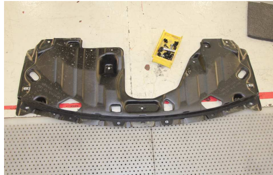
(d) OEM front panel with air dam
