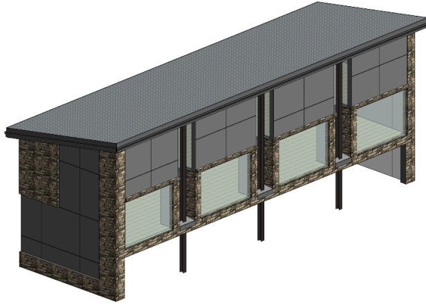
Figure 5.1 : Bâtiment OLB-P9 présentant une irrégularité de la rigidité verticale due à de grandes ouvertures au rez-de-chaussée
