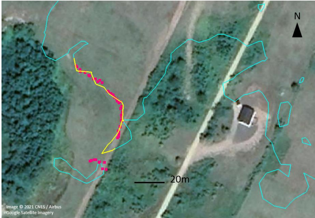
Figure 28. Comparaison des résultats modélisés aux données des points des relevés pour l'emplacement PB1. Le contour de la hauteur d'eau modélisée de 5 cm est indiqué en bleu. Une section du contour de la hauteur d'eau de 5 cm a été isolée (représentée en jaune). Les élévations du sol coïncidant avec le contour ont été comparées aux élévations des données des points des relevés (points roses). Les distances horizontales entre le contour de la crue modélisée et les points des relevés ont également été calculées.
