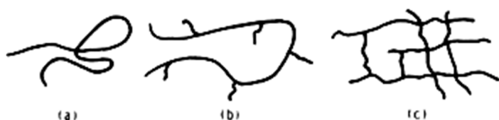
Figure 2. Représentation schématique des molécules polymères: (a) linéaire (b) ramifiée (c) tridimensionnelle (réticulée)
